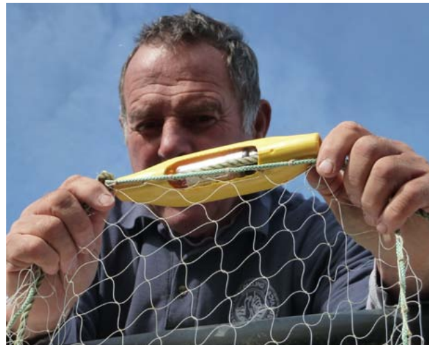
Brittisk fiskare med en s.k. Banana pinger.
